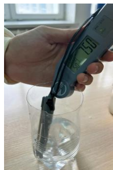
4-сурет. а- лас судың рН-метрі және ә- тазартылған судың рН-метрі
